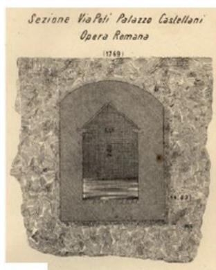
Fig. 6: Esempio di sezione fognaria Romana
