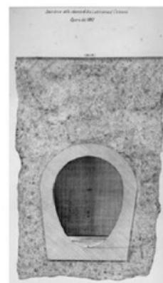
Fig. 8: Tubo fognario costruito lungo via
