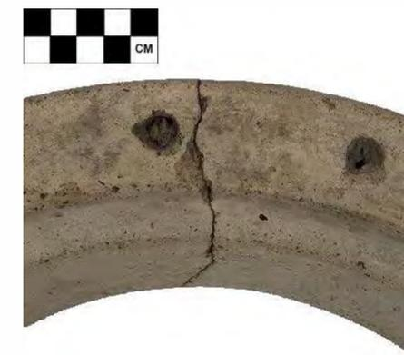
Fig. 6 Dettaglio dei fori con residui di piombo.
